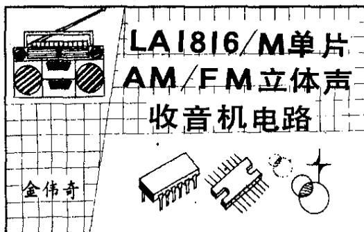
LA1816是日本三洋公司最新推出的AM/FM单片立体声收音机集成电路。其中LA1816采用24脚双列直插封装，LA1816M采用24脚双列扁平封装。这两种电路电参数一致，只是外形封装不同。该电路工作电源电压范围宽， $V_{CC} = 1.8\sim 6V$ ，典型值为3V；功耗很小，AM时静态电流为3mA，FM时静态电流为8.5mA；由于该集成电路集成度高，功能多，因此外围元件特少，并且有一个与众不同的优点是外围不需要接中周等大型元器件。
